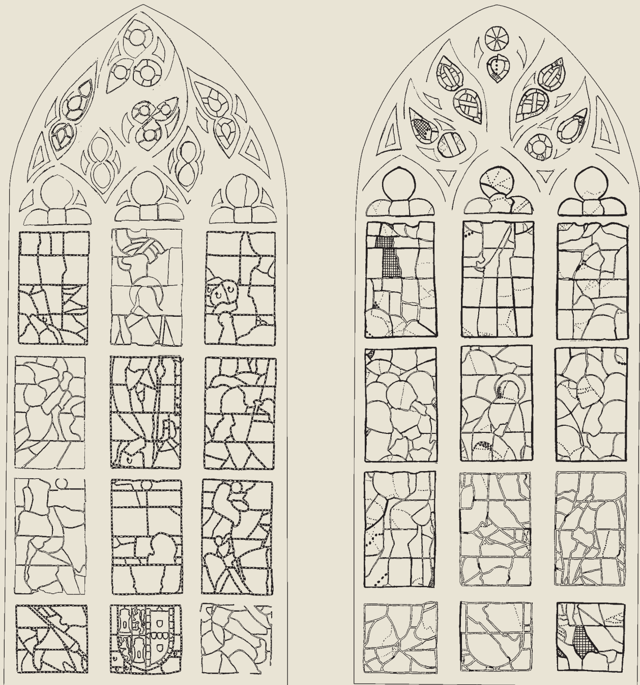
FIG. 35 Gráficos con códigos de cronologías del vidrio y del plomo y de intervenciones
